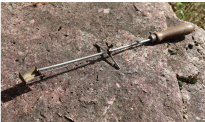
„Varroadieu“ – ein poetischer wie hoffnungsfroher Name für den ersten, an der Fischermühle konstruierten Oxalsäure-Verdampfer. (© Nick Leukhardt)
